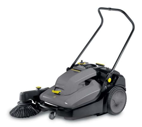
Handkehrmaschine mit elektrischem Kehrwalzen- und Seitenbesenantrieb für gleichermaßen gute Kehrwirkung in Links- und Rechtskurven. Universalbeborstung für Innen- und Außenreinigung, Staubfilter mit Absaugung, robuster Kunststoffrahmen, leicht einstellbare Hauptkehrwalze und stufenlos einstellbarer Seitenbesen.
