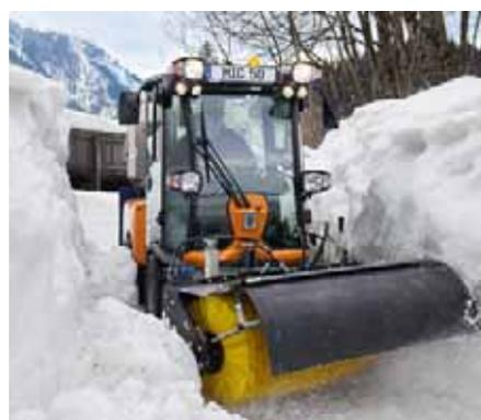
MIC 50, Frontkehrmaschine
